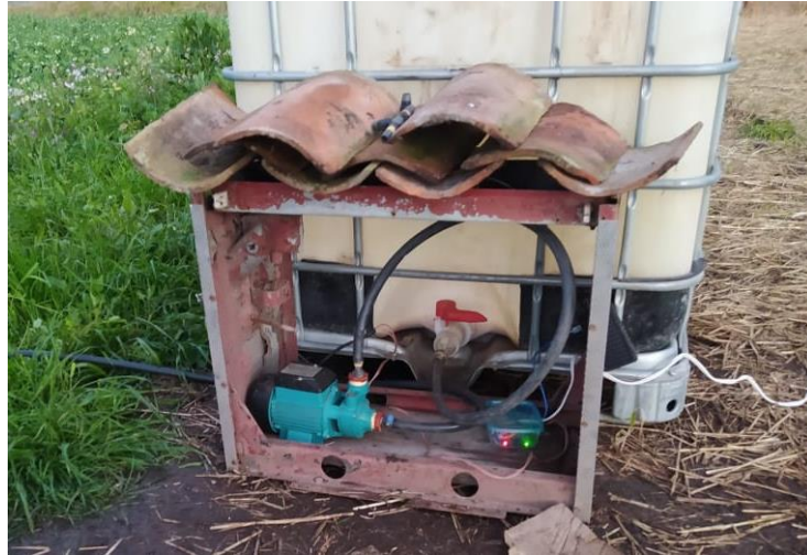
Figura 62. Instalación del nodo actuador en la parcela.
