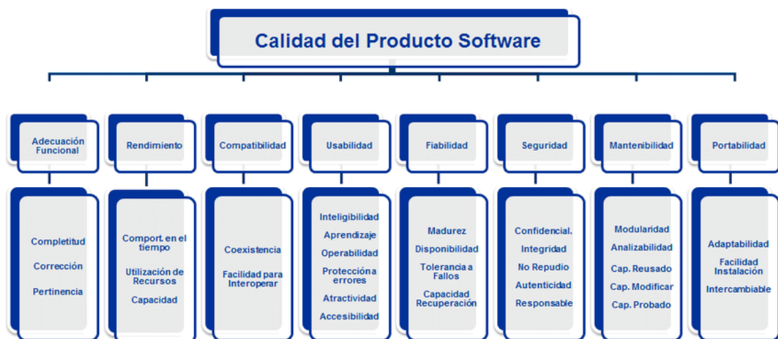
Figura 26. Modelo de calidad de software de la ISO/IEC 2501n.
