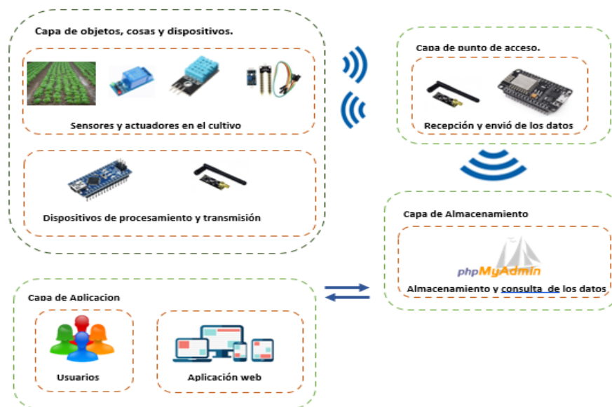
Figura 28. Vista de implementación del sistema.
