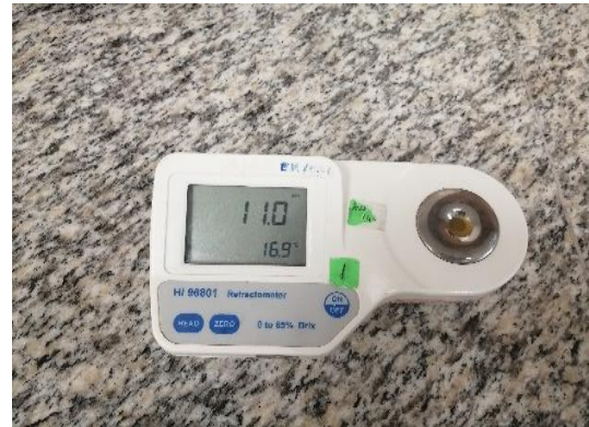
Figura 13. Medición de sólidos solubles
