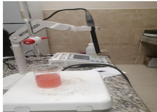
Figura 11. Medición de acidez
