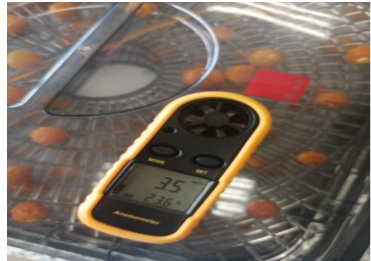
Figura 17. Control velocidad de aire anemómetro
