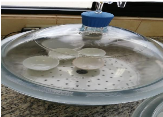
Figura 12. Determinación de humedad
