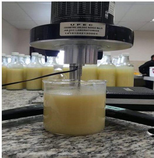
Figura 15. Determinación de la viscosidad
