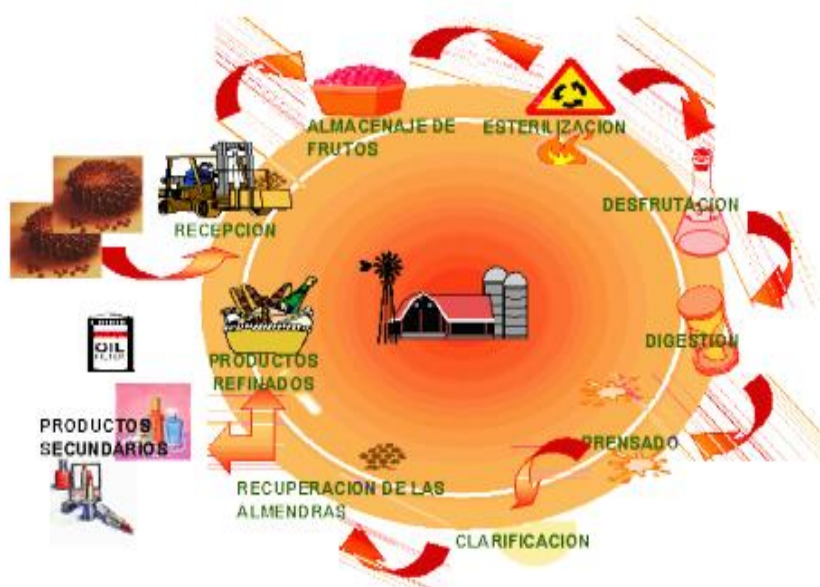
Figura 7 Proceso detallado de la extracción
