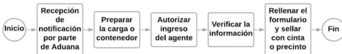
Figura 8: Diagrama de flujo para aforos físicos
