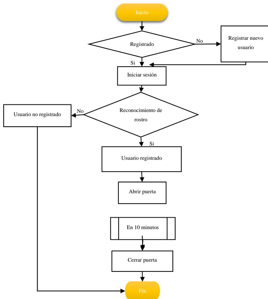
**Figura 13.** Diagrama de flujo de funcionamiento general del sistema.
