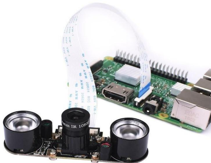
**Figura 6.** Cámara infrarroja para Raspberry PI.
