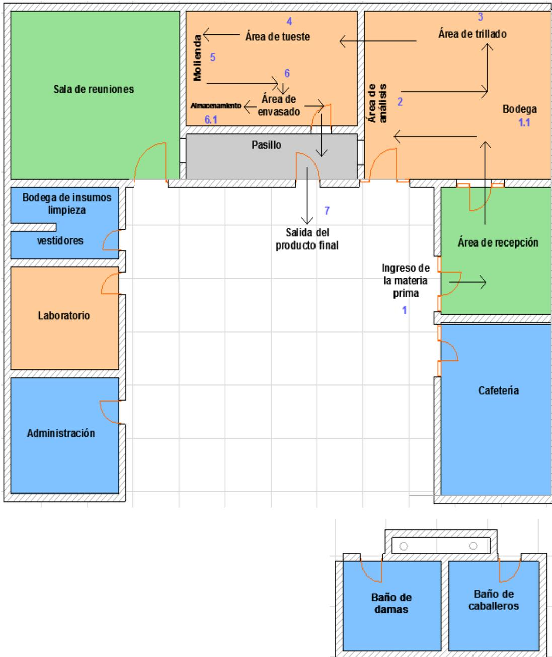
Figura 27. Esquema del recorrido del producto dentro del centro
