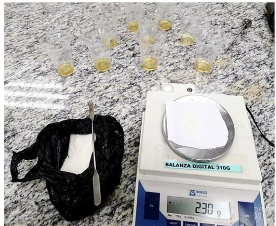
**Figura 18.** Pesado del azúcar para carbonatación
