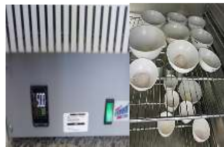
Figura 49. Determinación de ceniza (harina precocida y bebida instantánea).
