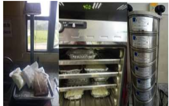
Figura 38. Estandarización de ingredientes ( 38\pm 2 °C), mezclado y tamizado.
