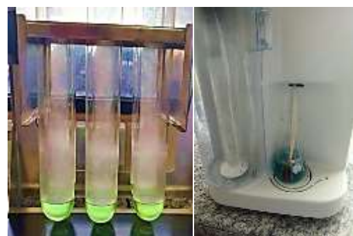
Figura 44. Determinación de proteína (harina precocida, bebida instantánea y reconstituida).
