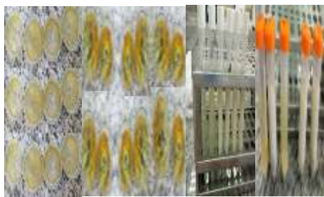
Figura 48. Determinación de índice de solubilidad, de absorción y de hinchamiento (harina precocida y bebida instantánea).
