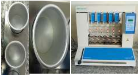
Figura 46. Determinación de grasa (harina precocida y bebida instantánea).
