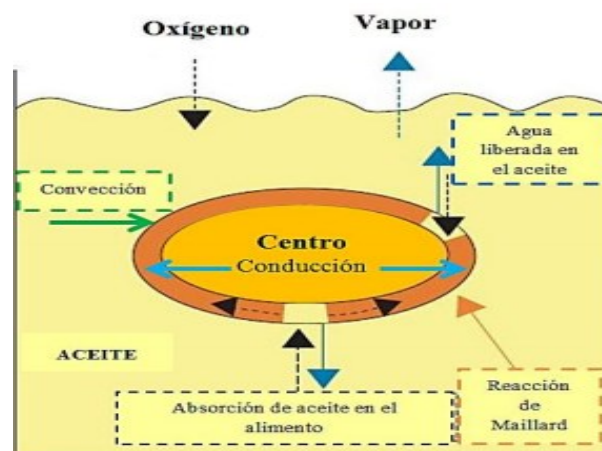
Figura 1 Transferencia de calor y masa durante el proceso de fritura. Fuente: (De la Cruz & Huaman, 2002)
