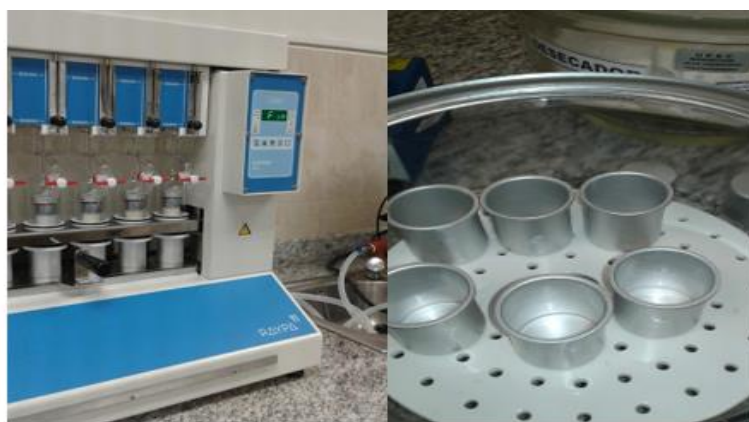
Figura 31. Análisis de grasa por Soxhlet
