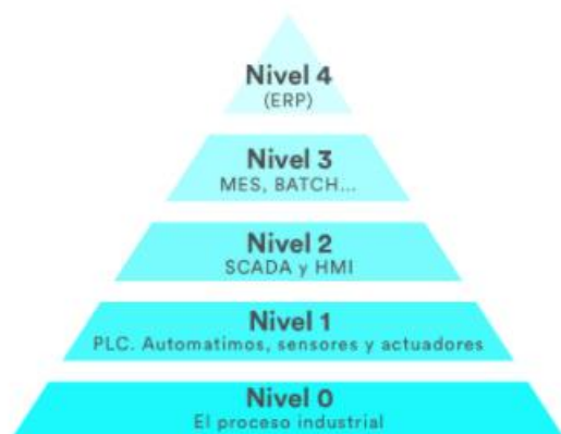
Figura 2: Pirámide automatización según modelo ISA-95
