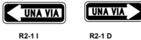
Figura 38. Una vía izquierda (R2-1I), o derecha (R2-1D).
