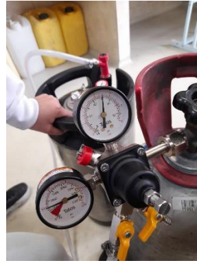
Figura 40. Gasificación a 20 PSI
