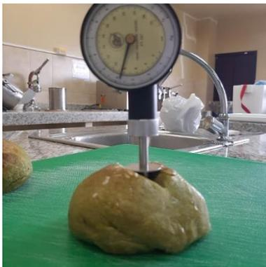
a. 39. Prueba reológica para determinar la textura del pan.
