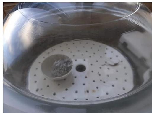
a. 18. Cenizas colocadas en el desecador para evitar la absorción de humedad.
