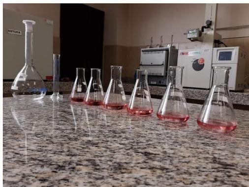
a. 33. Muestras homogeneizadas del pan, previamente pesadas para el proceso de digestión del método Kjendhal
