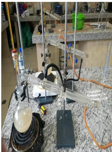
Figura 37: Primera destilación de los diferentes tratamientos sacando cabeza, cuerpo y cola a una temperatura de 85°C
