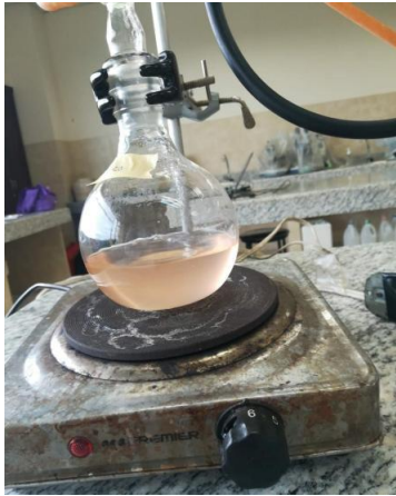
Figura 31: Hidrólisis ácida con el ácido sulfúrico a una temperatura de 140°
