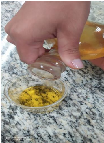
Figura 32: Prueba de Yodo, colocando tres gotas de Lugol a la solución hidrolizada
