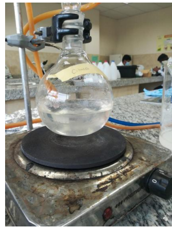
Figura 30: Hidrólisis ácida con ácido cítrico a una temperatura de 140°C
