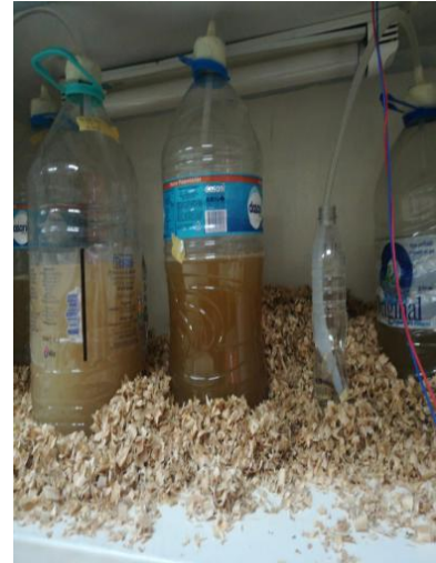
Figura 34: Fermentación de los tratamientos por 10 días a una temperatura de 35°C
