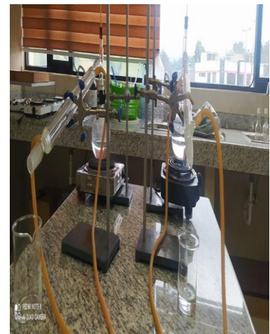
Figura 36: Segunda destilación de los diferentes tratamientos sacando cabeza, cuerpo y cola a una temperatura de 85°C
