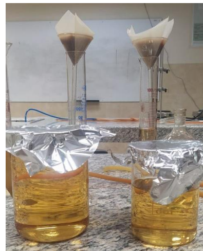
Figura 33: Filtración de la solución hidrolizada
