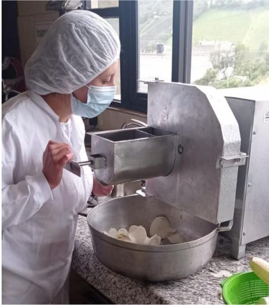
Rebanado por medio de cortadora de cuchillas rotatorias industrial para yucas de 1,5-1,8 mm.
