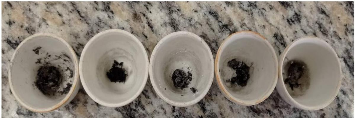
Determinación del contenido de fibra de chips de plátano y yuca después del proceso de calcinación.
