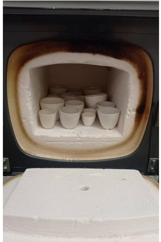
Determinación del contenido de cenizas de chips de plátano y yuca antes del proceso de calcinación en la mufla.
