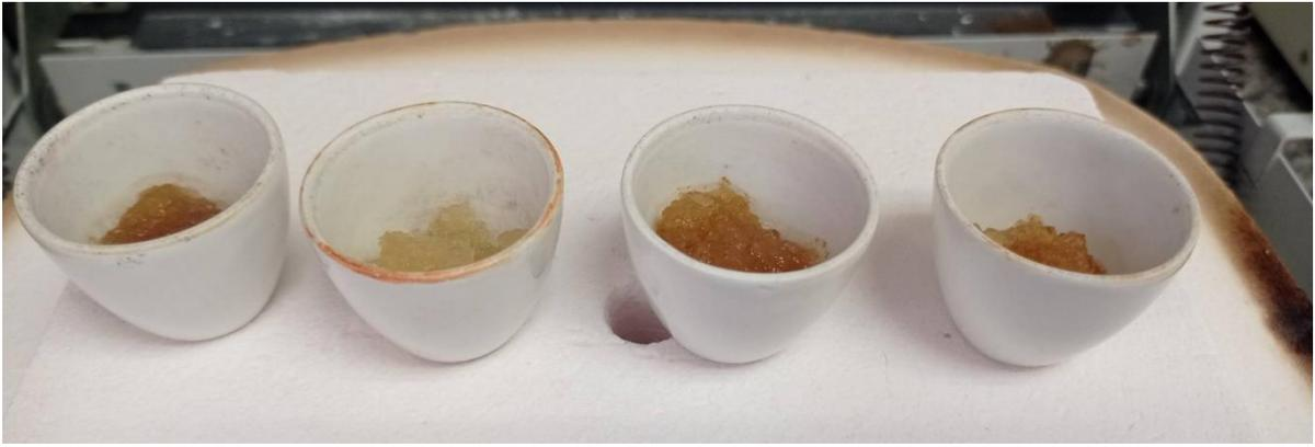
Determinación del contenido de fibra de chips de plátano y yuca antes del proceso de calcinación.
