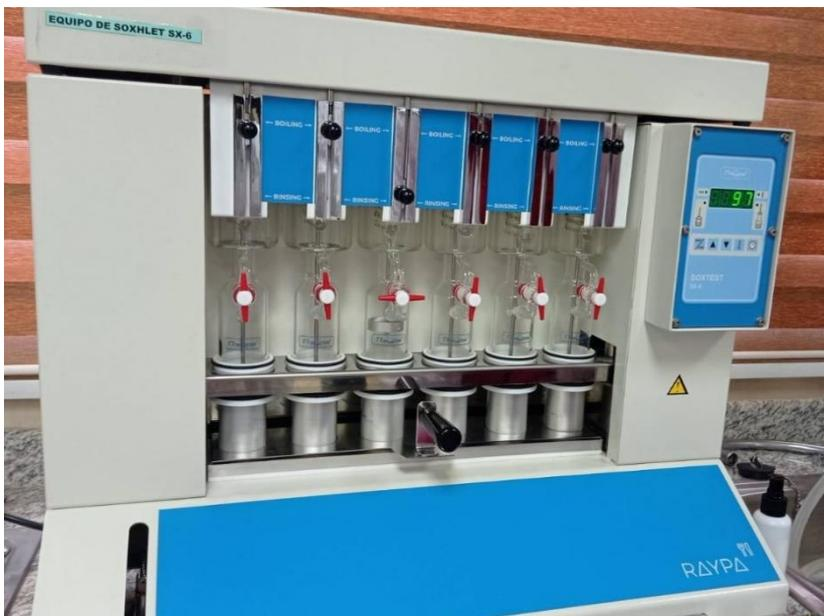
Determinación del contenido de grasa de chips de plátano y yuca obtenidos a través de varios tratamientos de cocción usando el equipo de Soxhlet
