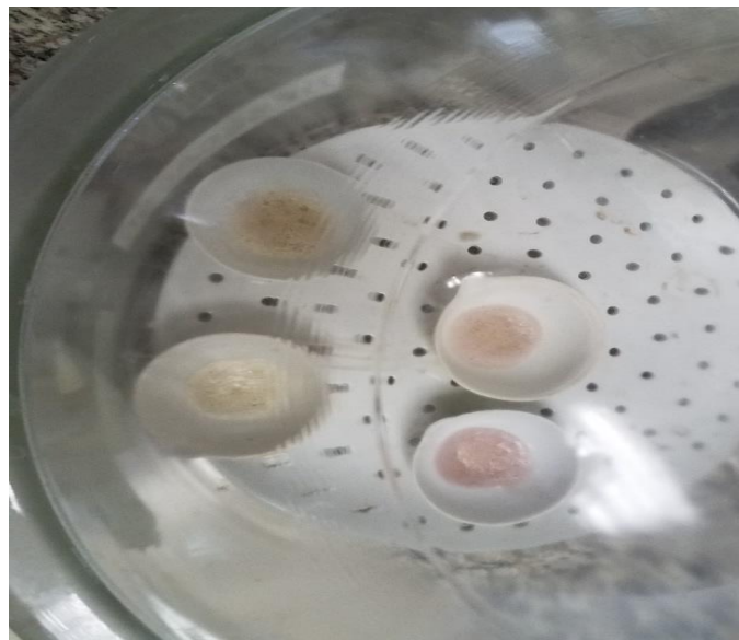
Figura 26. Enfriado de muestras en el desecador próximas a pesaje.
