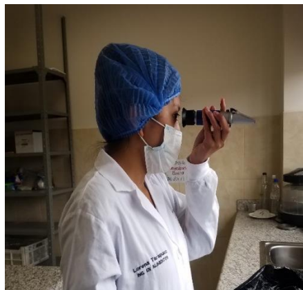
Figura 23. Determinación de grados BRIX de la materia prima.
