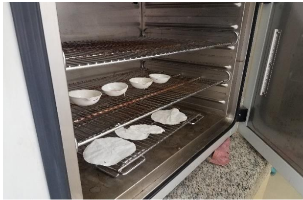
Figura 25. Determinación de humedad en estufa a 105 °C.
