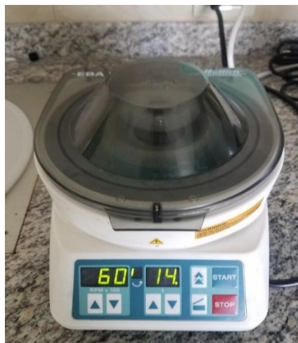
Figura 10. Centrifugación de la muestra de mora y fresa.
