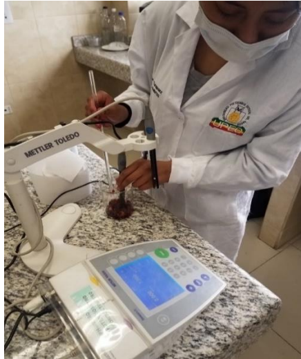
Figura 24. Medición del pH de las muestras.
