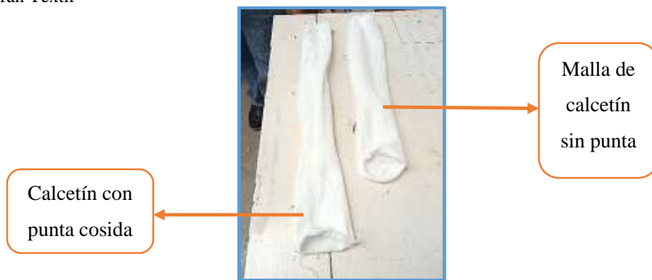
Figura 31: Diferencia entre malla de calcetín sin punta y calcetín con punta cosida Fuente Morán Textil
