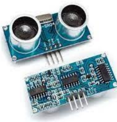
Figura 3 Sensor Ultrasónico. MEDIR DISTANCIA CON ARDUINO Y SENSOR DE ULTRASONIDOS HC-SR04. Fuente: Ingeniería, informática y diseño Llamas (2015)
