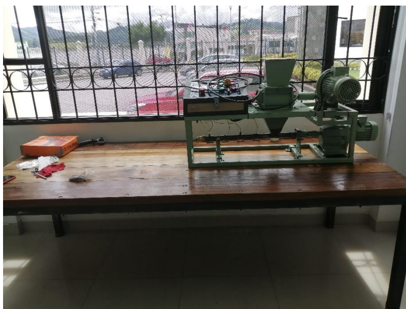
Figura 57 Extrusora de elaboración de filamento sin el post procesado
