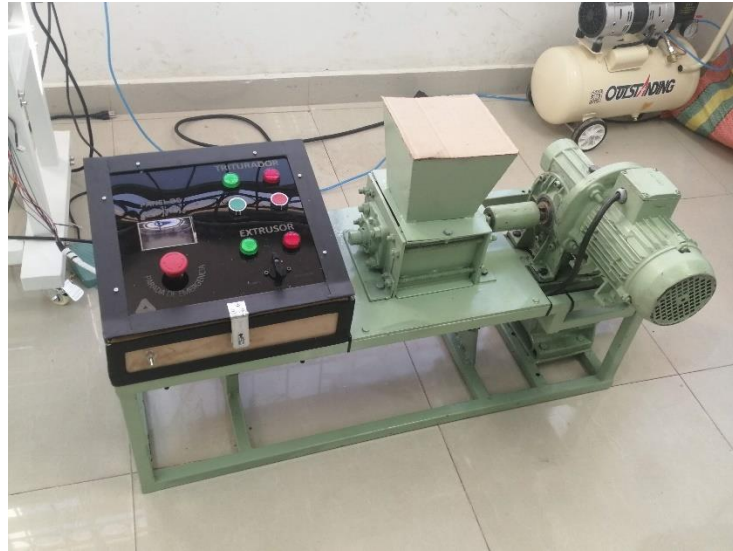
Figura 52 Extrusora de elaboración de filamento sin base y seguros para su seguridad.
