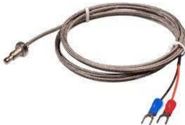
Figura 2 Sensor tipo K. TERMOCUPLA TIPO K - 2M X 150MM DE PUNTA (6 PULGADAS), PERMITE SENSAR UN RANGO DE TEMPERATURA DE 0-400°C.
