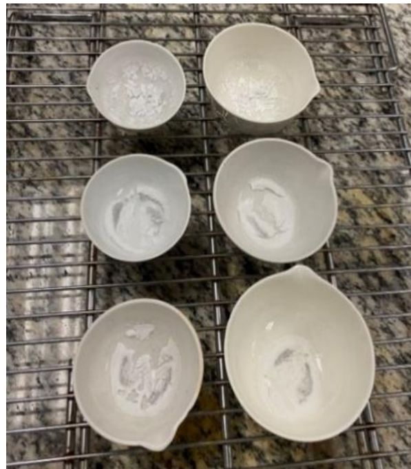
Figura 9. Análisis de ceniza: Cápsulas con ceniza de mortadela
