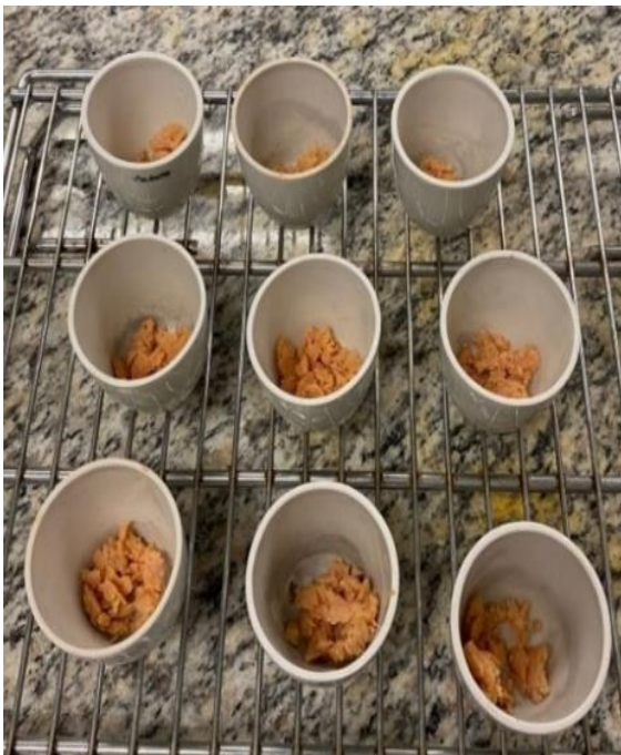
Figura 8. Análisis de humedad: Muestras de mortadela sin humedad
