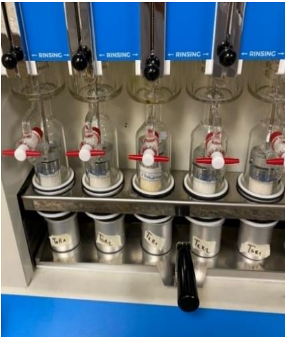
Figura 10. Análisis de grasa: Equipo de Soxhlet con muestras de mortadela
