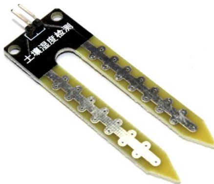
Figura 18. Sensor de humedad a tierra
