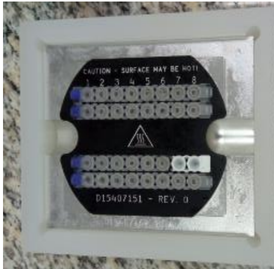
Figura 40. Bloque de enfriamiento
