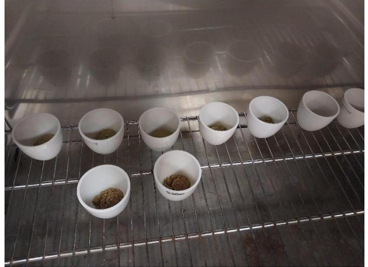
**Figura 25.** Análisis de humedad. Muestras de enzima sin humedad
