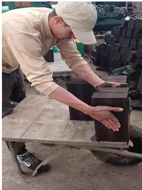
Para trasladar los ladrillos al lugar de almacenamiento se utilizan las carretillas sacadoras mismas que tienen la capacidad de trasladar 24 ladrillos por viaje. Para evitar que los ladrillos se peguen en la carretilla no se los encima y además antes de colocarlos en la carretilla se espolvorea ceniza.
