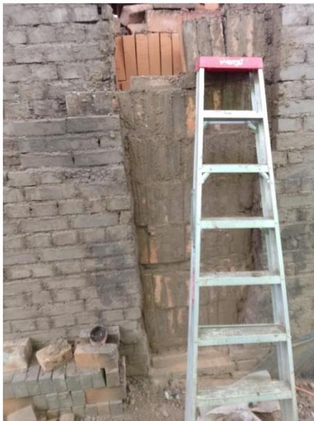
Tras inspeccionar que todos los lugares que requieren sellarse estén adecuados, se prosigue con el encendido de las bocas del horno, que consiste en meter leña en los agujeros bajo todos los ladrillos que se cocinan. Para que el fuego llegue a la temperatura adecuada de 1000°C A 1100°C se procede a encender dos ventiladores.
