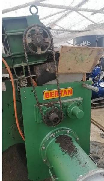
En esta misma máquina se adapta los moldes según los tipos de ladrillo o bloques y tamaños que requiera realizar. Hoy hay 15 moldes diferentes. Cada molde debe ser fabricado por empresas especializadas en estos productos puesto que sus medidas son milimétricas y al ser realizados de manera artesanal no logran cumplir con el funcionamiento adecuadamente, el costo de cada uno es de 1.500\$.
