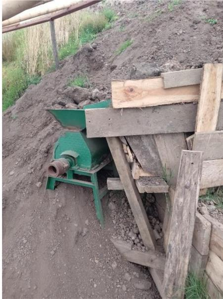
La máquina quebradora lo que hace es desmenuzar a los terrones de las diferentes materias primas para que tengan la misma consistencia y grosor. Este proceso ayuda a mezclar todas las materias primas.
