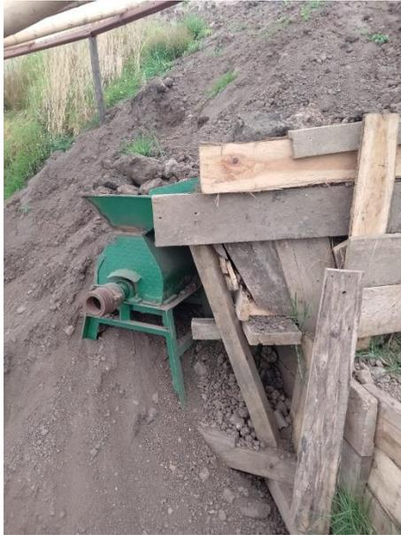
La máquina quebradora lo que hace es desmenuzar a los terrones de las diferentes materias primas para que tengan la misma consistencia y grosor. Este proceso ayuda a mezclar toda la materia prima.
