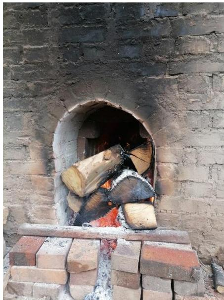
Finalmente se retiran los ventiladores y para mantener la temperatura adecuada y conseguir que los ladrillos se cocinen se debe colocar leña durante 6 días y 5 noches avivando el fuego y revisando que el proceso de cocción se lleve a cabo de la mejor manera. Este tiempo se requiere para el ladrillo de tipo tradicional o compacto.
