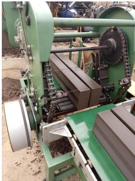
En el momento en que la cortadora termina, gracias al mecanismo rotatorio de una especie de banda los ladrillos terminados se expulsan para que dos de los trabajadores de la empresa los trasladen hacia el lugar de almacenamiento. En esta etapa es probable que los ladrillos tengan malformaciones por lo que no se los almacena, sino que se los vuelve a colocar a la extrusora para que repitan el proceso y salgan con las características correctas.
