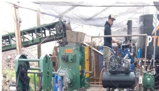
En esta misma máquina se adapta los moldes según los tipos de ladrillo y tamaños que requiera realizar. Hoy hay 15 moldes diferentes. Cada molde debe ser fabricado por empresas especializadas en estos productos puesto que sus medidas son milimétricas y al ser realizados de manera artesanal no logran cumplir con el funcionamiento adecuadamente, el costo de cada uno es de \$ 100,00\$.
