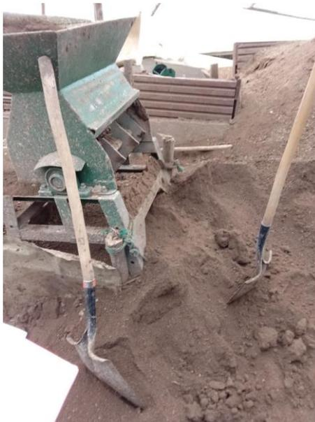
Cuando termina la maquina quebradora de moler la materia prima, esta queda depositada en un lugar específico debajo de una cubierta de invernadero cerca de la maquina laminadora. Tres de los obreros que trabajan en la empresa arruman la materia prima ya pulverizada o desmenuzada a la maquina laminadora que hace que la materia prima adopte maleabilidad gracias a que consigue la humedad necesaria, pues esta expulsa a la materia prima en forma de tallarines.
