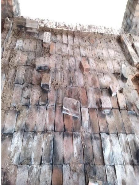
Al haber terminado la actividad antes mencionada se prosigue a cerrar la puerta/as del horno utilizando ladrillos defectuosos y además barro para evitar la fuga de las llamas o calor del horno.
