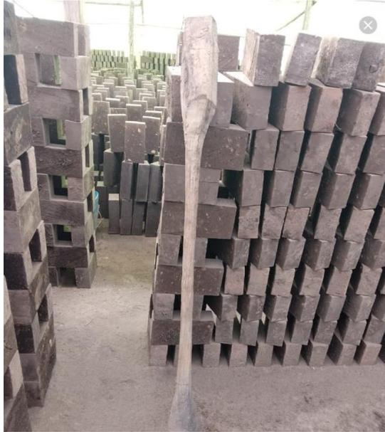
Después de que el ladrillo pase por el secado se inicia con el proceso de cocción, donde se arruma el ladrillo en el o los hornos por las puertas del mismo hasta el tope con ayuda de los obreros que usan las carretillas para facilitar esta actividad. Los ladrillos son colocados de tal manera que entre ellos se forman soportes para seguir colocándolos uno sobre otro, además se dejan especies de zanjas en las esquinas o alrededor del horno para que cuando se encienda el calor sea uniforme.
