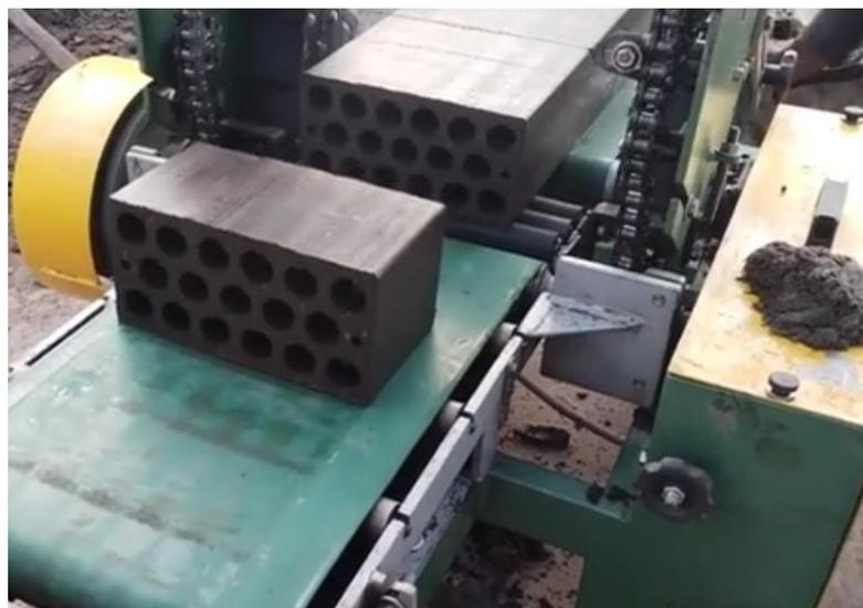
En el momento en que la cortadora termina, gracias al mecanismo rotatorio de una especie de banda, los bloques terminados se expulsan para que dos de los trabajadores de la empresa los trasladen hacia
