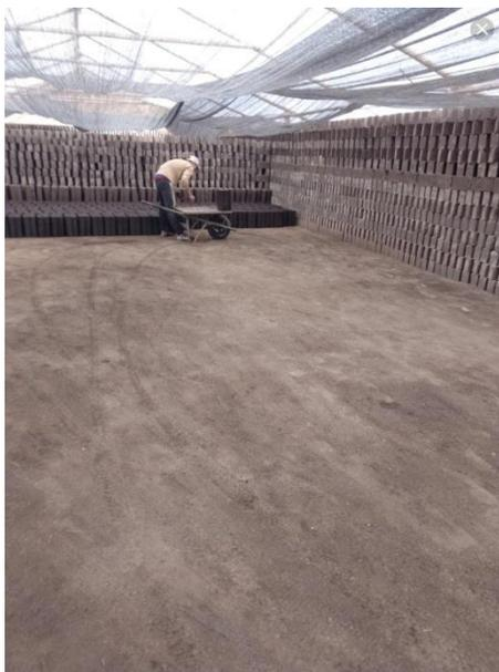
En el lugar de almacenamiento se da inicio al proceso de secado donde los ladrillos permanecen por 8 días en sombra con ayuda de una malla especial, este tiempo se requiere para los ladrillos de tipo compacto o tradicional de medidas de: 29cm de largo, 8cm de grueso y 15cm de ancho.
