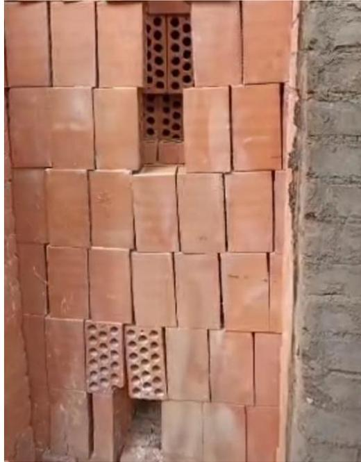
Tras inspeccionar que todos los lugares que requieren sellarse estén adecuados, se prosigue con el encendido de las bocas del horno, que consiste en meter leña en los agujeros bajo todos los bloques farol que se queman. Para que el fuego llegue a la temperatura adecuada de 1000°C A 1100°C se procede a encender dos ventiladores.
