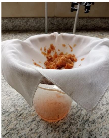
Figura 11. Filtración de la cáscara después de la inactivación enzimática
