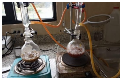
Figura 12. Hidrólisis ácida (ácido cítrico y ácido clorhídrico por calor)
