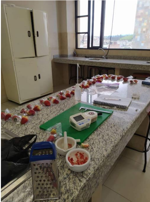
Figura 9. Toma de datos el ancho, largo, peso, °Brix y pH de la fresa.
