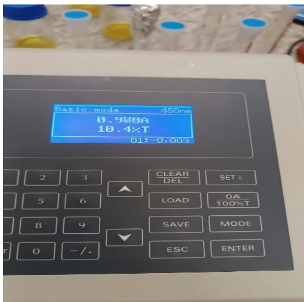
Figura 13. Medición de la absorbancia mediante espectrofotometría UV-Visible.
