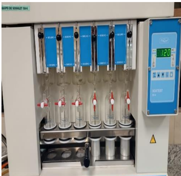
Figura 11. Extracción del pigmento mediante Soxhlet
