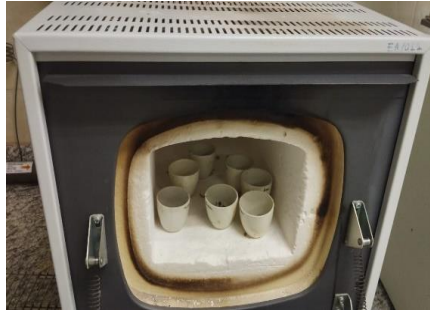
Figura 16. Análisis de ceniza en mufla
