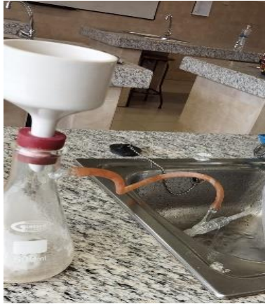
Figura 13. Filtrado con bomba al vacío
