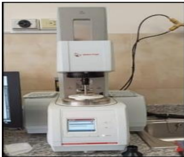
Figura 3. Reómetro modelo Anton Par 302
