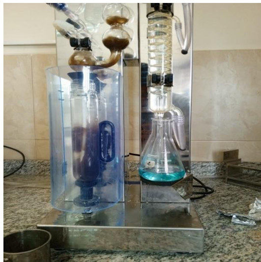
Figura 64. Obtención de Nitrógeno por arrastre de vapor.
