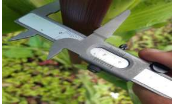
Figura 22. Medición del grosor del tallo con un del dendrómetro "Pie de rey"
