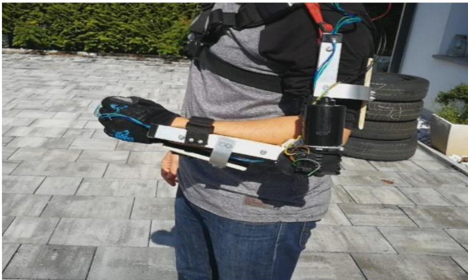
Figura 4. Prototipo del Exo-brazo Fuente: (Yúbal Fernández, 2017)
