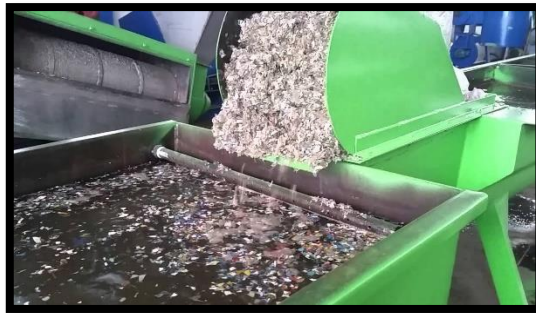
Figura 48. Lavado de plástico. Fuente: Planta Procesadora "Plastic Planet".
