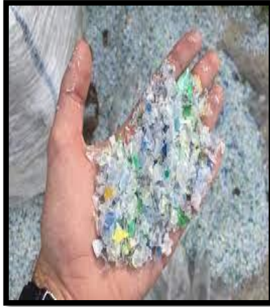
Figura 47. Molido de plástico en partículas pequeñas. Fuente: Planta Procesadora "Plastic Planet".
