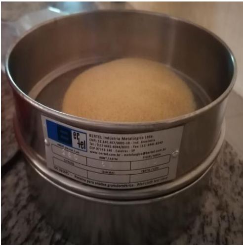
Figura 21. Proceso de tamizado de la harina de papa
