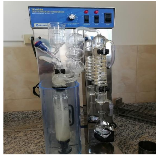
Figura 56. Colocación los tubos de digestión.
