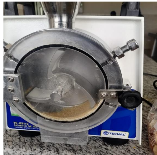
Figura 28. Proceso de molienda de los granos de quinua deshidratados.
