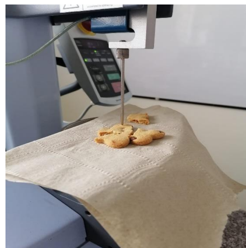
Figura 62. Prueba de dureza y fracturabilidad en la galleta.
