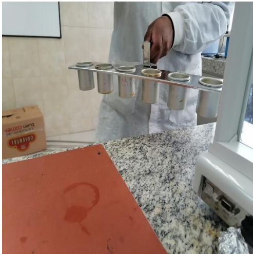
Figura 51. Lavado y desinfección de los depósitos metálicos de grasa.
