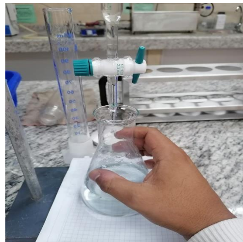
Figura 58. Titulación y anotación de los resultados para los respectivos cálculos
