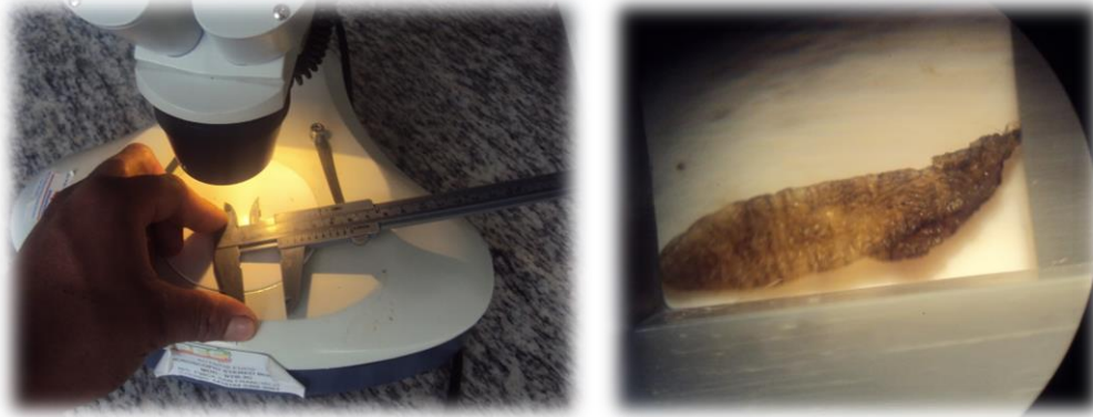
Fotografía 16: Medición con el calibrador y la ayuda del estereoscopio.
