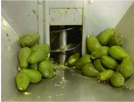
Tolva de deshuesado y descortésado
