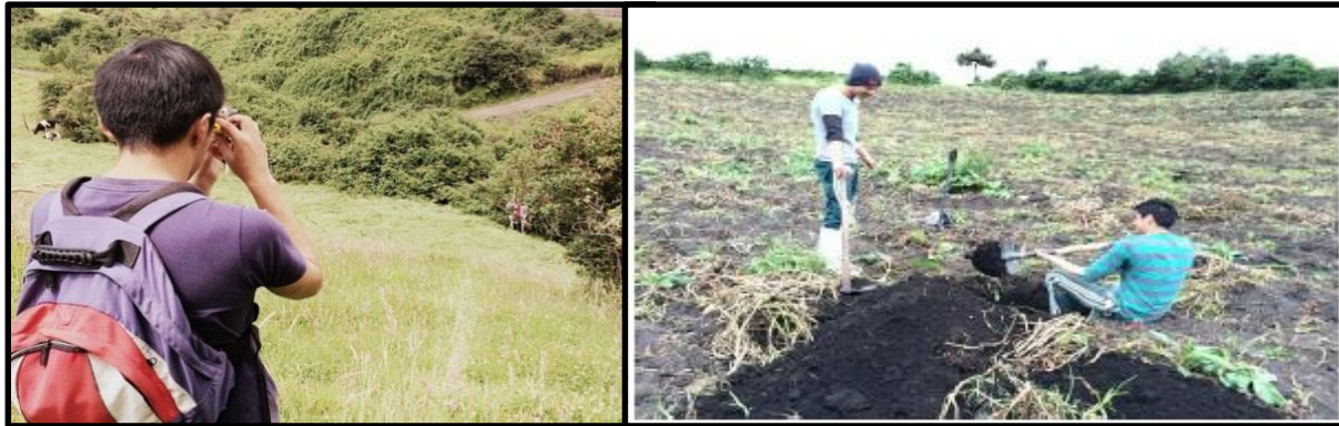
Figura 2: Medición de pendientes con clisímetro y apertura del suelo de 1m x 1m con azadón (Rosero, 2016)
