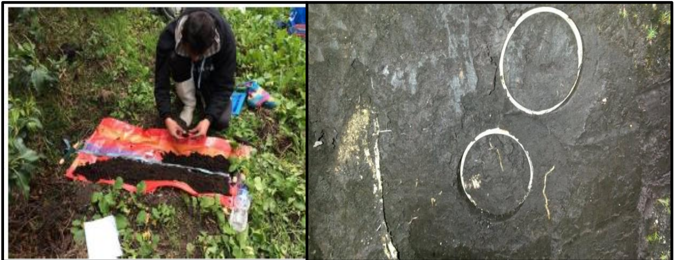
Figura 6: Recolección de 1 kg de suelo para análisis de pH, Carbono y muestras con cilindros para densidad aparente (Quintero, 2015)
