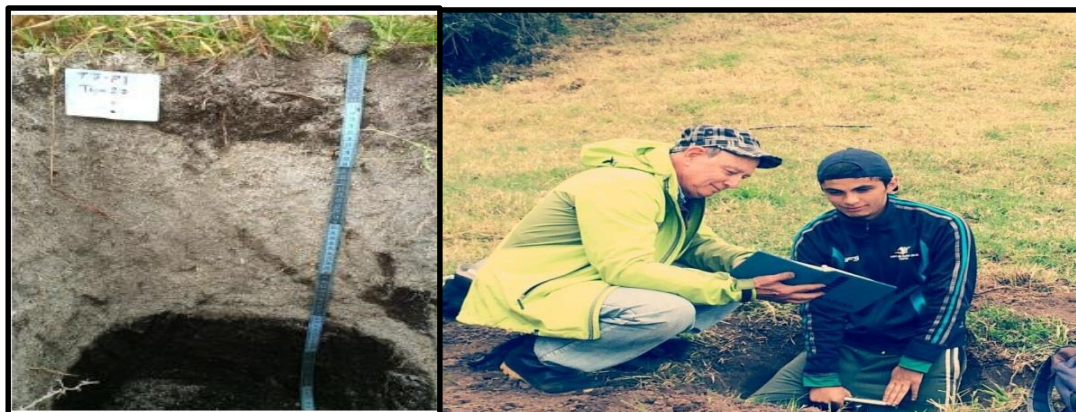
Figura 4: Preparación y medición del espesor de cada horizonte del suelo y observación de coloración del suelo en la tabla de Munsell(Rosero, 2016)
