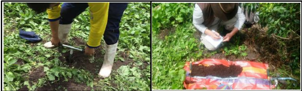
Figura 3: Barrenamientos en áreas hasta 1,20 cm de profundidad, posterior a la descripción de textura y estructura del suelo (Rosero, 2016)
