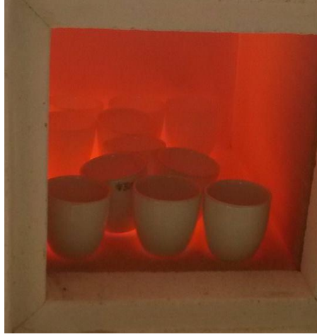
Figura 9: Muestras de carbono a 425 grados centígrados en la mufla (Rosero,2016)
