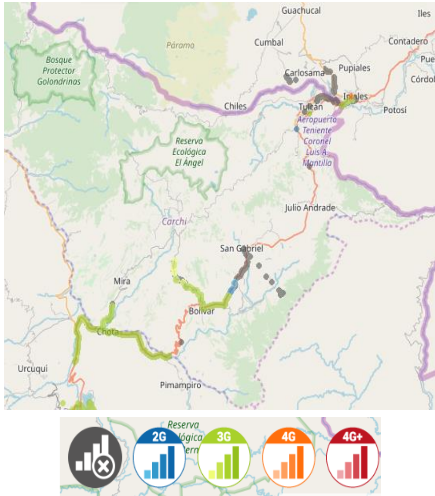
Figura 21: Mapa de cobertura 2G / 3G / 4G Movistar en la provincia del Carchi Fuente: nperf
