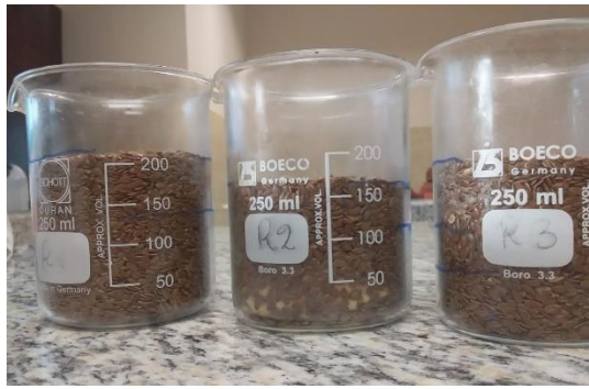
Figura 30. Determinación de volumen específico mediante desplazamiento de semillas.
