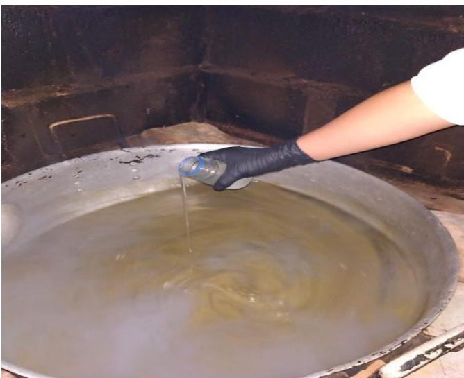
Figura 11. Aplicación de Flocculante
