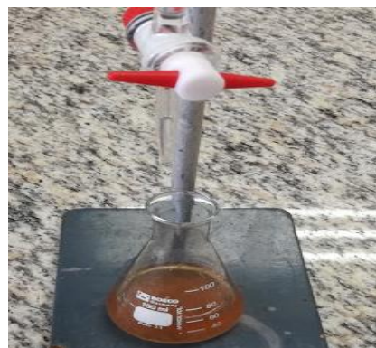
Figura 18. Medición de acidez
