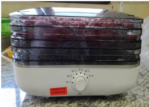
Figura 23. Deshidratador de base eléctrica con ventilador turbo y corriente de aire caliente
