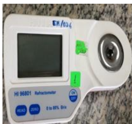
Figura 20. Medición de sólidos solubles
