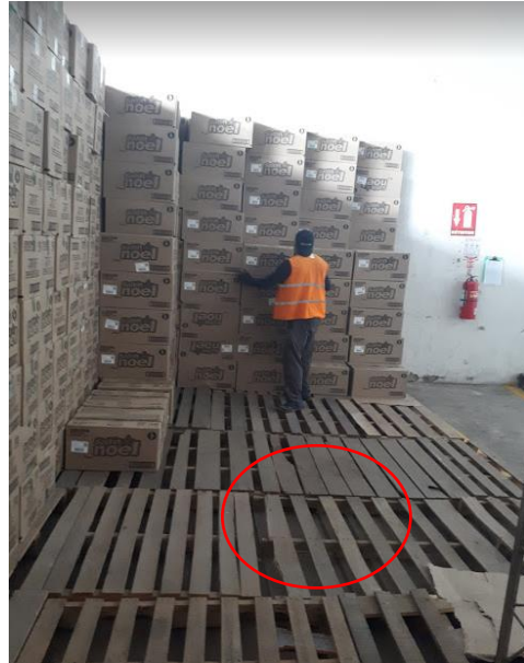
Los pallets no se encuentran en buenas condiciones
