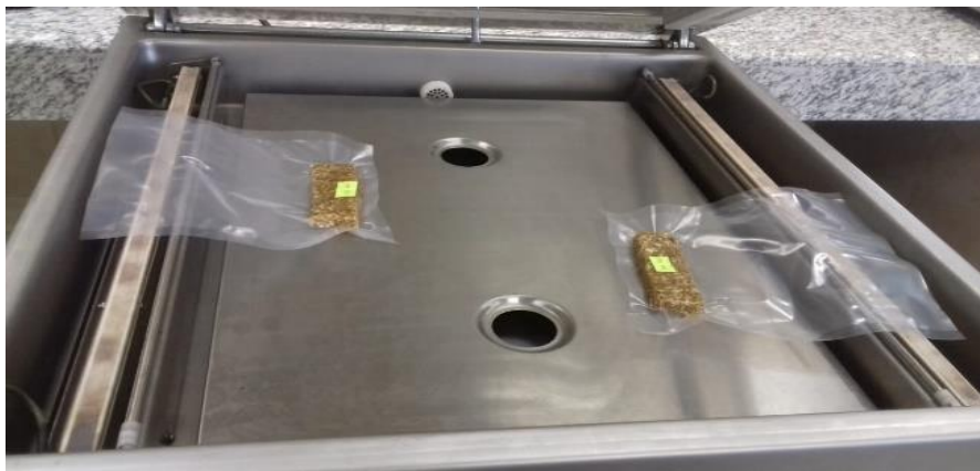
Figura 5. Empacado al vacío de las barras energéticas
