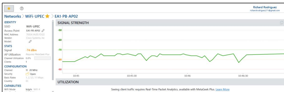
Figura 63. Análisis señal Edificio Aulas 1 planta baja Access Point 2
