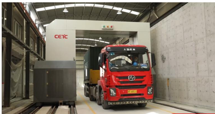
Ilustración 24. Tipo de Scanner: Portal fijo
