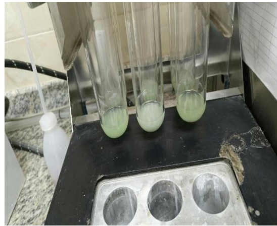
Figura 11. Método de Kjeldahl para determinar la proteína del yogur.
