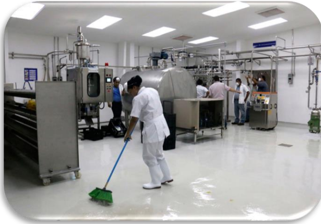
Gráfico 6.- Pisos y paredes idóneos para industria láctea.
