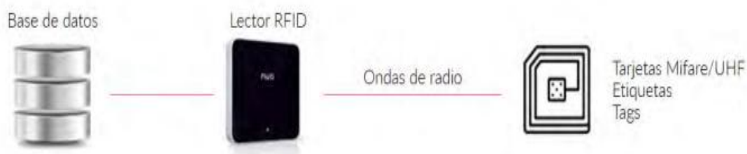
Esquema de operación de la tecnología RFID
