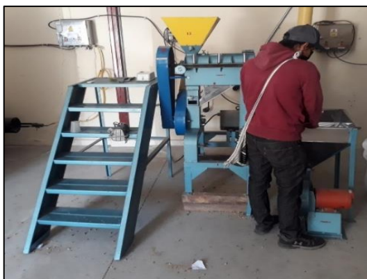
Figura 31: Trilladora de capacidad de 45,5 kg
