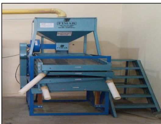
Figura 32: Clasificadora de granos de capacidad de 45,5 kg
