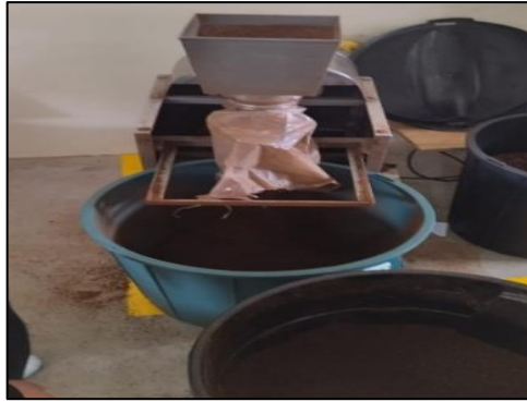
Figura 35: Molino de café de capacidad de 18,95 kg
