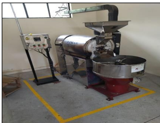
Figura 33: Tostadora industrial de capacidad de 15 kg
