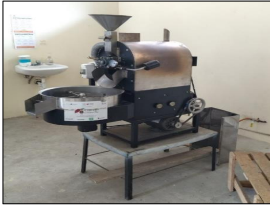
Figura 34: Tostadora industrial de capacidad de 2kg
