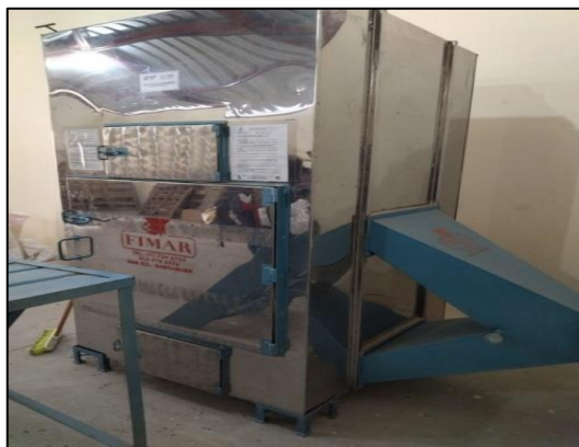
Figura 29: Máquina secadora de capacidad de 182 kg
